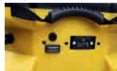
Панель управления CDX 20, таймер наработки часов
