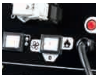
Регулировка мощности: 80 кВт и 110 кВт
