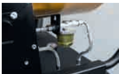
Топливный фильтр снаружи, устройство предварительного нагрева топлива - опция
